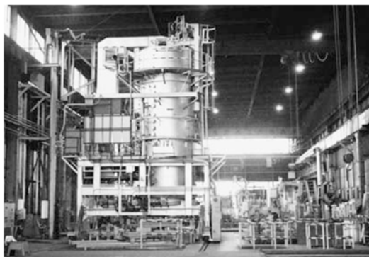
宇宙航空機器部品などの熱処理を行うガントリ型熱処理設備
